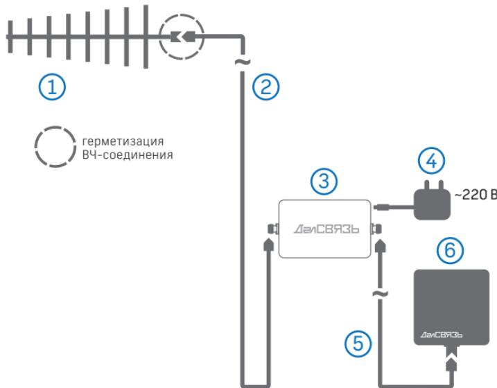
1 – Внешняя антенна, направленная на базовую станцию
